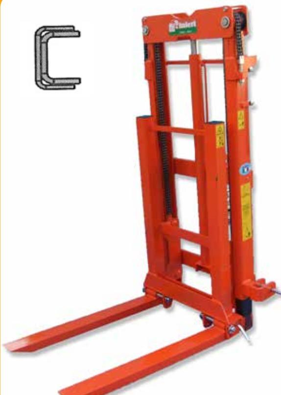
**Modello con profili in lamiera piegata e bussole di scorrimento, con carichi da 800 a 1500 kg e distributore idraulico di serie.**
