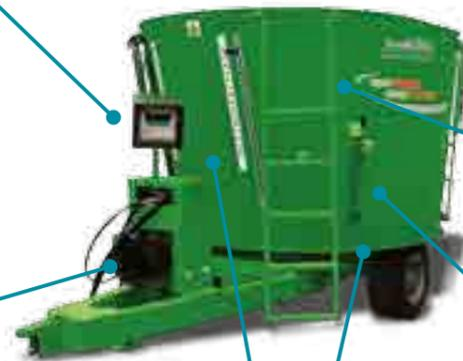
Die gewalzten und 8 mm starken Behälterwände sowie die 20 mm dicken Behälterböden garantieren einen sorglosen Arbeitsvorgang und eine lange Lebensdauer.
