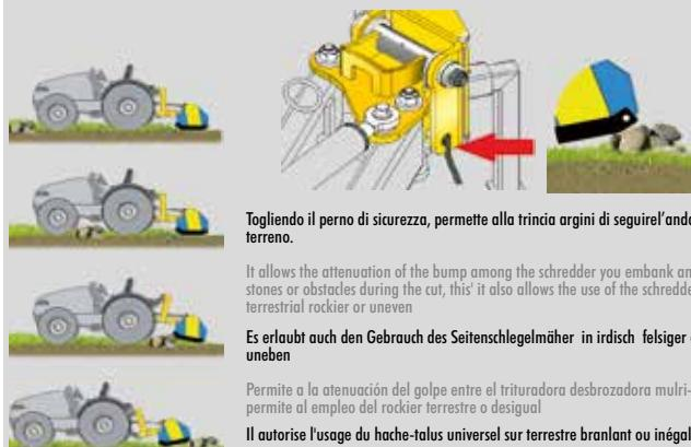
Togliendo il perno di sicurezza, permette alla trincia argini di seguire l'andamento del terreno.
