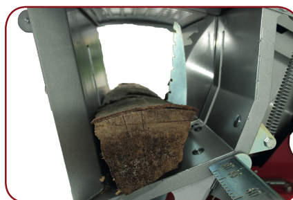
Der Niederhalter verhindert ein Verdrehen des Holzes
