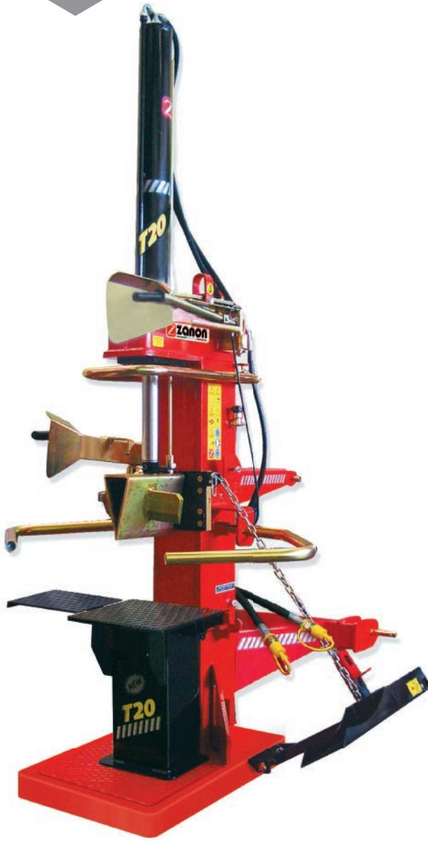
**Impiego:** lo spaccalegna SVI-20 ha una spinta di 20 tonnellate e consente di spaccare tronchi di legno di dimensioni variabili, fino a 110 cm di altezza. La linea SVI-Pesante è dedicata all'uso professionale ed è fornita di serie con cilindro da 1050 mm. È dotato di un sistema automatico di controllo finecorsa registrabile e di appositi dispositivi di sicurezza che tutelano l'utilizzatore.
